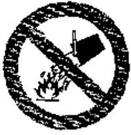
Verboden met water te blussen
