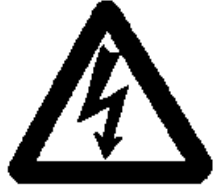
Gevaar voor elektrische spanning
